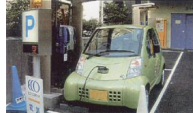
急速EV充電器の例
