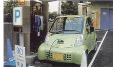
急速EV充電器の例
